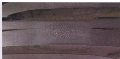
圖5. 電阻銲點良好試片。
