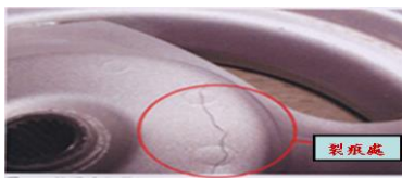
圖 3. 巨觀觀察:輪圈本體生成之裂縫
