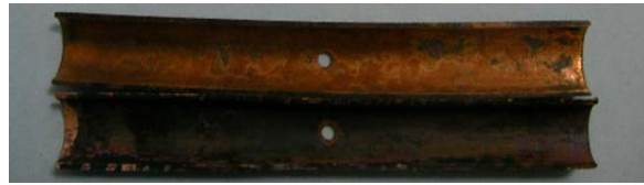
圖 7 以自來水浸泡銅管使用電化學反應 7 日後之表面狀況
