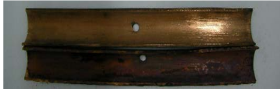
圖 5 以純水浸泡銅管使用電化學反應 7 日後之表面狀況
