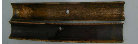
圖 6 以地下水浸泡銅管使用電化學反應 7 日後之表面狀況
