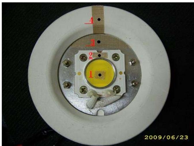
圖 9 溫度觀察點(1.晶片、2.基板、3.散熱塊、4.陶瓷)
