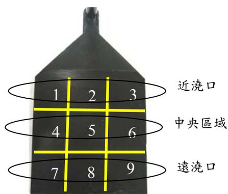
圖 7 平面電阻量測示意圖
