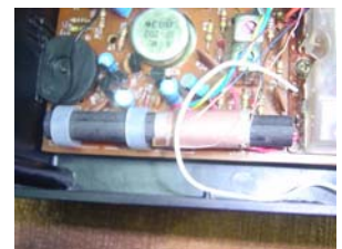
搭接圓型礦石晶體至 電路板上
