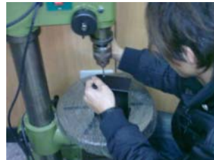
先規劃出鑽口位子 之後在機台上加工
