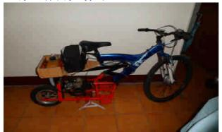
在製作完成時,測試因本身有割草機引擎重量,加上輪轂式電動馬達,還有電瓶重量重了許多,在完全使用電動馬達騎乘下大約最高速20~25 km/hr,整顆電瓶充飽電大約能騎 20 公里。
